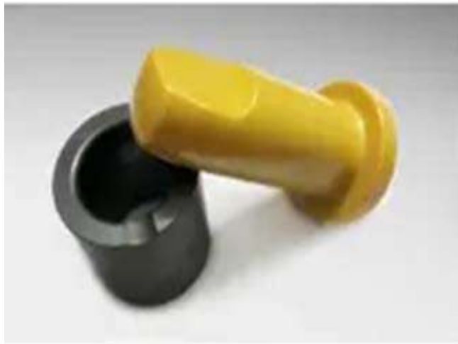
Рис.1 Подшипник из карбида кремния, (Star Ceram), и скользящий валик из оксида циркония.
