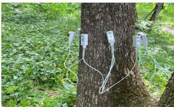
Рис. 1. Размещение датчиков на стволе деревьев и пути акустических измерений
